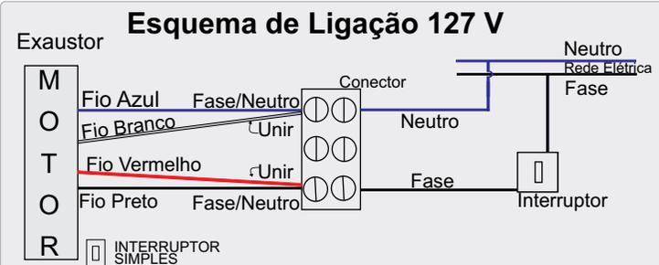
Utilizando o interruptor da luz ambiente ou interruptor independente. Para tensão 220 V entre fases recomendamos o uso de um interruptor bipolar.
